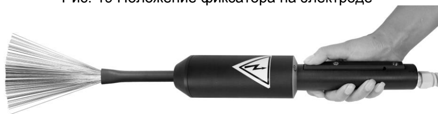
Рис. 20 Положение электрода, закрепленного в высоковольтном трансформаторе-держателе
