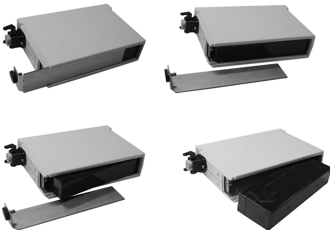
Рис. 30. Последовательность действий при замене аккумулятора
