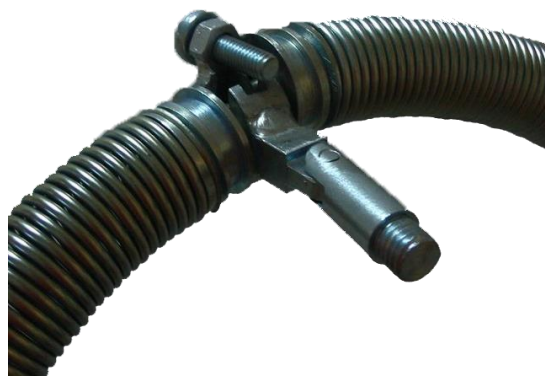
Рис. 22. Подготовленный к проведению контроля пружинный электрод
