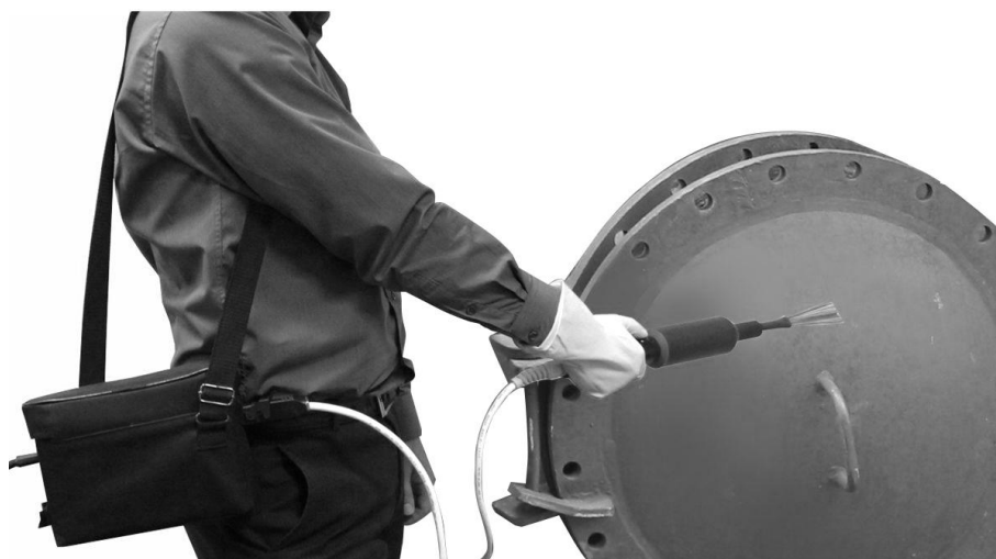
Рис. 21. Положение прибора при проведении контроля
