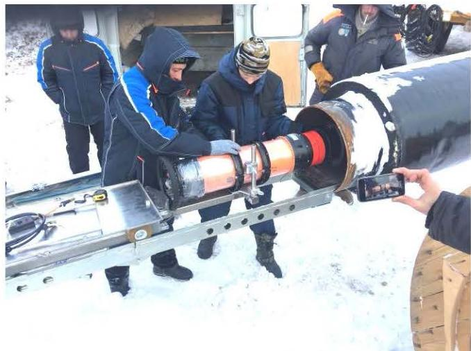
Объект контроля: труба диаметром 530мм, толщиной стенки 9 мм, теплоизоляция толщиной 100мм, внешний защитный слой 1 мм. Исходя из предыдущего опыта были определены параметры экспозиции: напряжение 180кВ, ток 3,2mA, время 20 сек. Следует отметить, что настройка кроулеров и рентгеновского аппарата происходит непосредственно с панели управления кроулеров, на дисплее которого также отображается информация о текущем состоянии батарей и рентгеновского аппарата.
