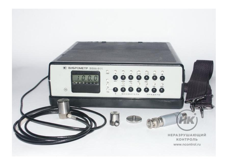
Портативный виброметр ВВМ-311 с цифровым индикатором предназначен для измерения параметров вибрации (виброускорение, виброскорость, виброперемещение) работающего оборудования, машин и других объектов в лабораторных и производственных условиях.
