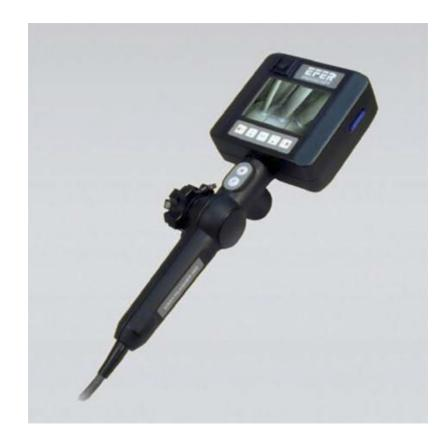
Боковой обзор с помощью сменной насадки d 11.6 мм (зеркало). Механическое управление изгибом дистальной части в 4-х направлениях на угол 150°. VGA экран с диагональю 90 мм (3.5 дюйма). Запись видеоизображения (формат MPEG 4), цифровое фото (формат JPEG) в режиме реального времени на 2 Гб SD-карту.
