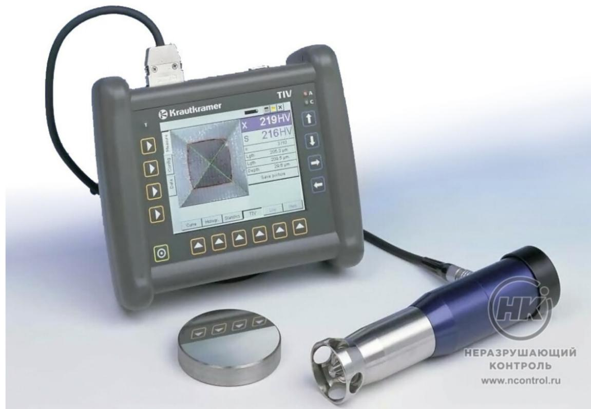
Метод TIV (Through Indenter Viewing) является следующим шагом, использующим современные технологии, в области экспресс-измерений твердости. Этот эффективный оптический метод, базирующийся на методе определения твердости по Виккерсу, позволяет через индентор – алмазную пирамидку по Виккерсу – при применении специальной оптической системы, увидеть весь процесс измерения. Изображение отпечатка передается и обрабатывается после приложения к зонду номинальной нагрузки. Снят с производства.
