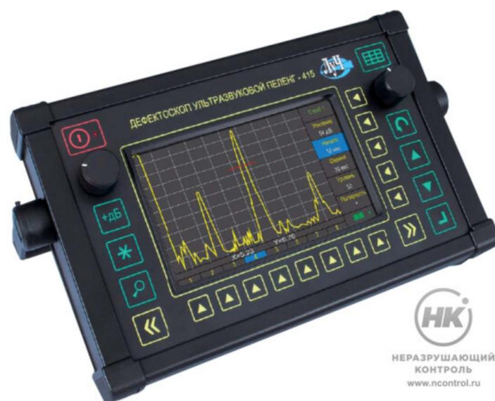
Ультразвуковой дефектоскоп «ПЕЛЕНГ-415» предназначен для работы в составе многоканальных автоматизированных и механизированных установок. Работает с механизированными многоканальными сканерами. Диапазон контроля по стали: от 2 до 15 000 мм.
