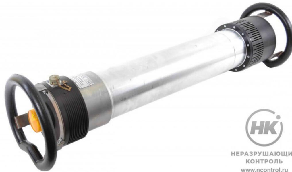
Рентгеновские аппараты постоянного потенциала «Радон-250» предназначены для контроля трубопроводов, сварных швов и металлоконструкций.
