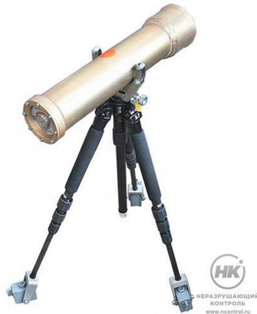
Рентгеновский аппарат РПД-150 С просвечивает объекты с радиационной толщиной до 20 мм по стали. Фокусное расстояние — 400 мм, время экспозиции — 10 минут. Анодное напряжение, ток рентгеновской трубки и время экспозиции регулируются. Северная версия предназначена для работы при температуре до  $-40^{\circ}\text{C}$ .
