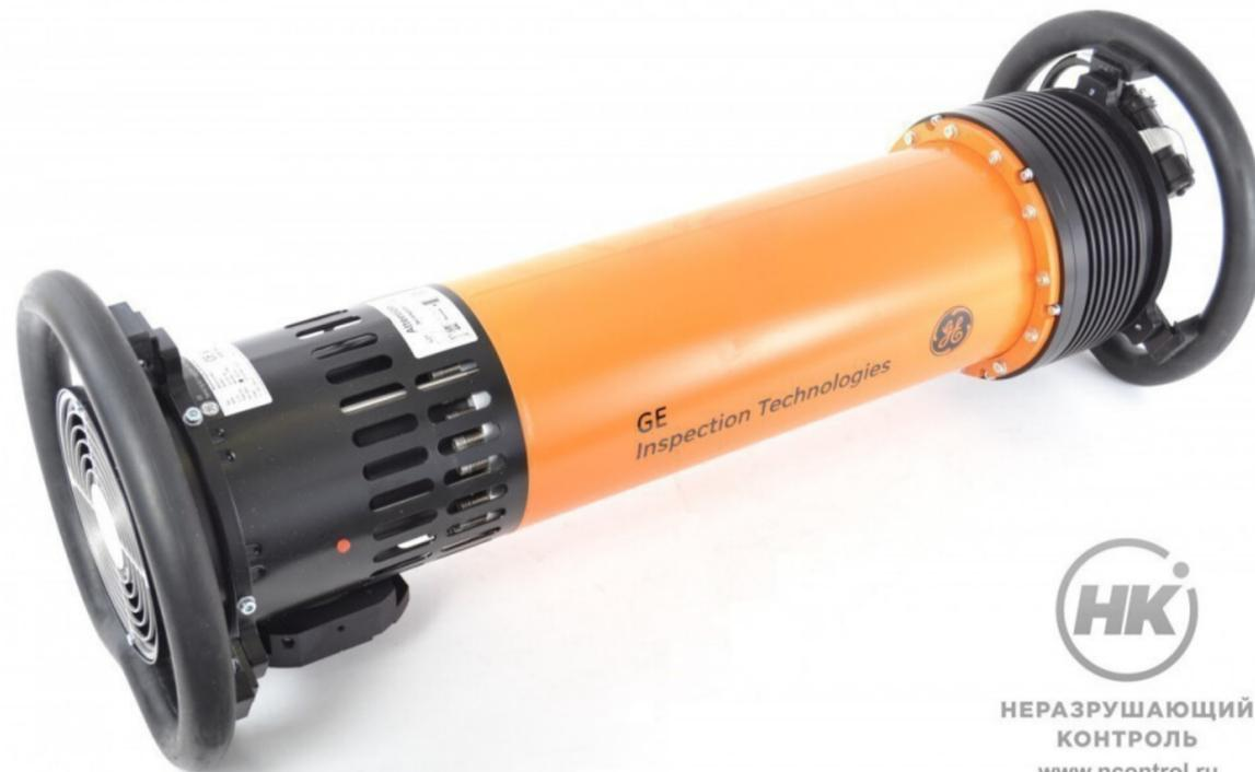
Переносной рентгеновский аппарат Eresco 42 MF4 предназначен для направленного просвечивания объектов. Диапазон напряжения: от 5 до 200 кВ. Просвечиваемая толщина стали — 42 мм.
