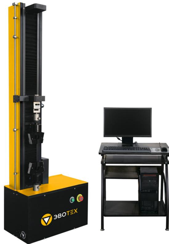
Одноколонная универсальная испытательная машина ЭВО-M02-1 / ЭВО-M02-1В (увеличенная рабочая зона) предназначена для проведения механических испытаний в режимах растяжения, сжатия и изгиба образцов и изделий, изготовленных из различных материалов, включая металлы, древесину, резину, пластмассы, текстиль и другие.
