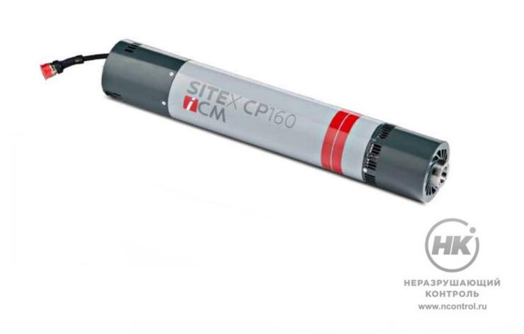
SITE-X CP160CR — компактный панорамный рентгеновский генератор постоянного потенциала, предназначенный для работы в составе кроулера. Применяется для контроля кольцевых сварных соединений трубопроводов диаметром от 6 дюймов. Напряжение регулируется в диапазоне от 40 до 160 кВ. Проникновение в сталь составляет 28 мм при просвечивании из центра трубы диаметром 18 дюймов, экспозиции 10 мин, на плёнку D7, оптическая плотность D=2.
