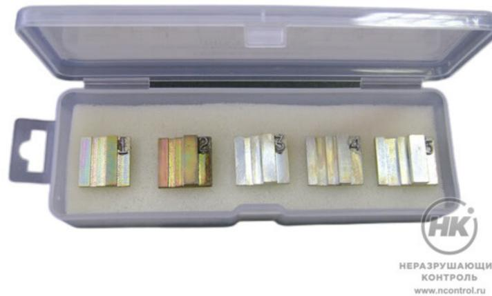
Комплект выпуклых и вогнутых образцов-имитаторов предназначен для контроля качества корневых сварных соединений на труднодоступных участках. Подходит для работы с денситометром.
