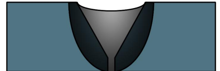
Глубина вогнутости шва считается допустимой, если на радиографическом снимке оптическая плотность вогнутости корня шва меньше или равна оптической плотности изображения канавки образца-имитатора.
