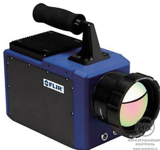
Тепловизор FLIR серии SC7000 — универсальный прибор, работающий в широком динамическом диапазоне. Разработан для научных и промышленных исследований. В зависимости от модели и детектора тепловизор позволяет снимать с частотой кадров до 62 кГц.
