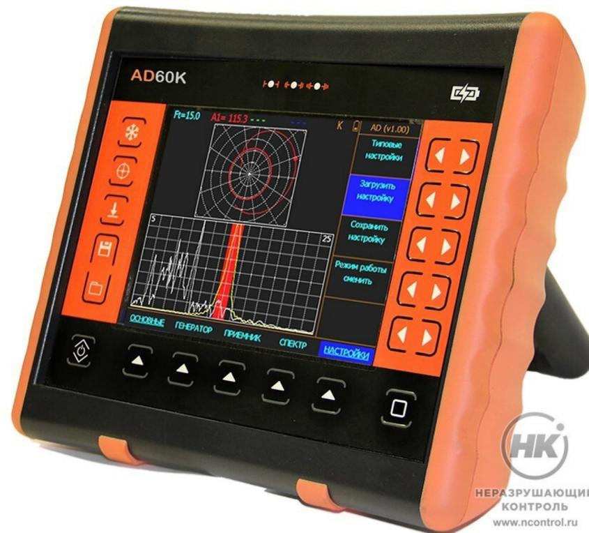
Акустический дефектоскоп АД-60К имеет генератор импульсного возбуждения и позволяет работать как импедансным методом, так и методом свободных колебаний. Применяется для определения расслоений, непроклея, внутренних дефектов структуры материала.
